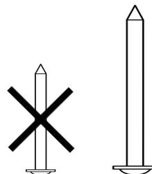
Per i materiali con uno spessore di 30/40 mm, utilizzare le viti di lunghezza corrispondente fornite con il telaio del tavolo.
