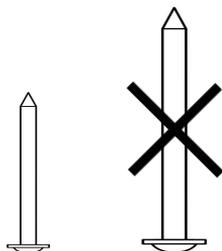
Per i materiali con uno spessore di 20 mm, utilizzare le viti corte corrispondenti fornite con il piano del tavolo.
