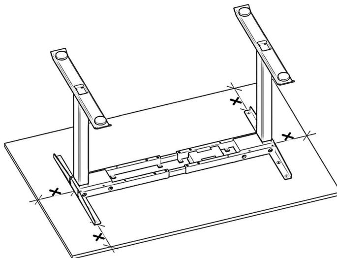
Il telaio viene quindi fissato alla parte inferiore del piano del tavolo con le viti appropriate. I supporti del telaio sono dotati di appositi fori.
